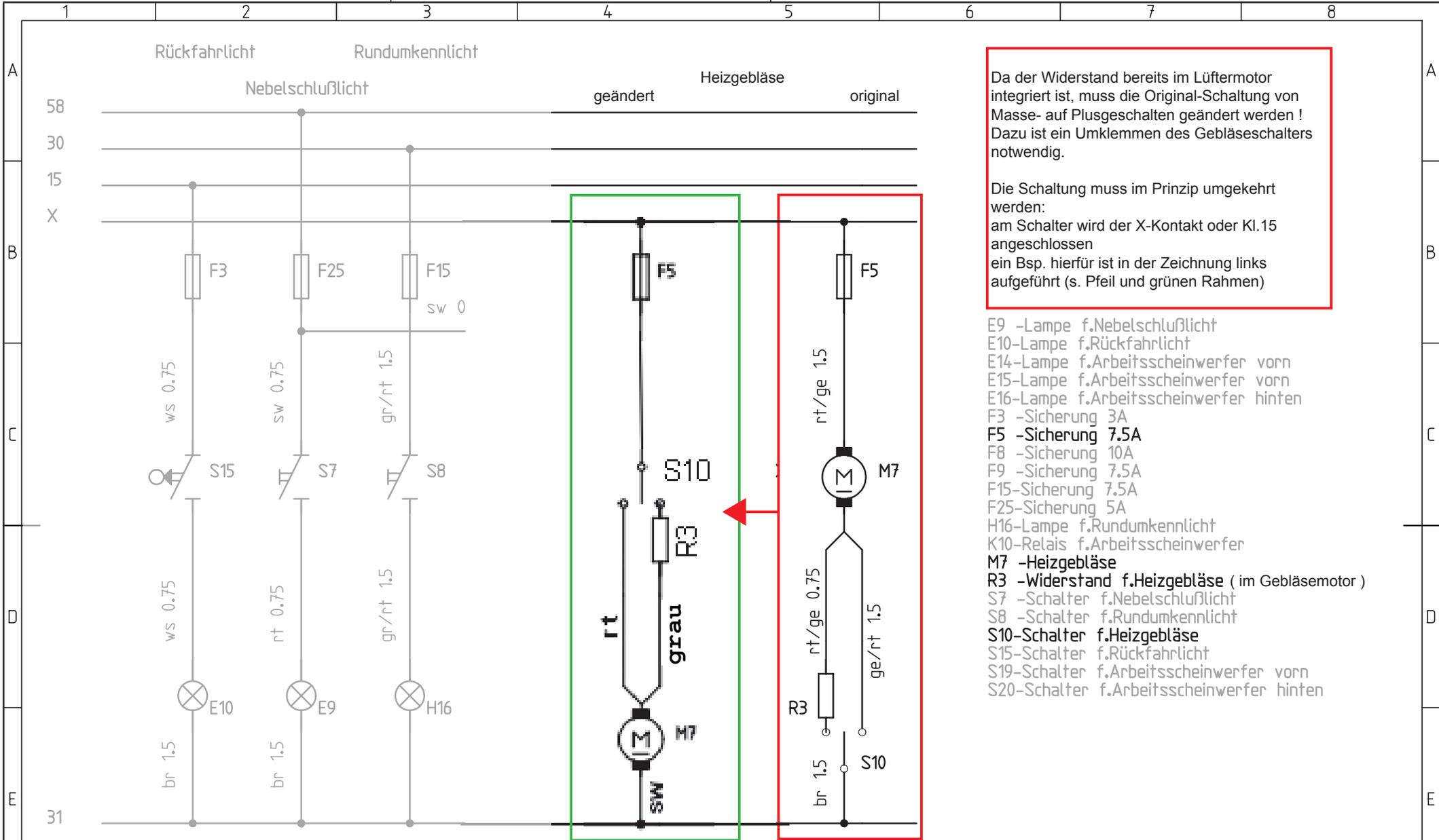
Da der Widerstand bereits im Lüftermotor integriert ist, muss die Original-Schaltung von Masse- auf Plusgeschalten geändert werden ! Dazu ist ein Umklemmen des Gebläseschalters notwendig.
